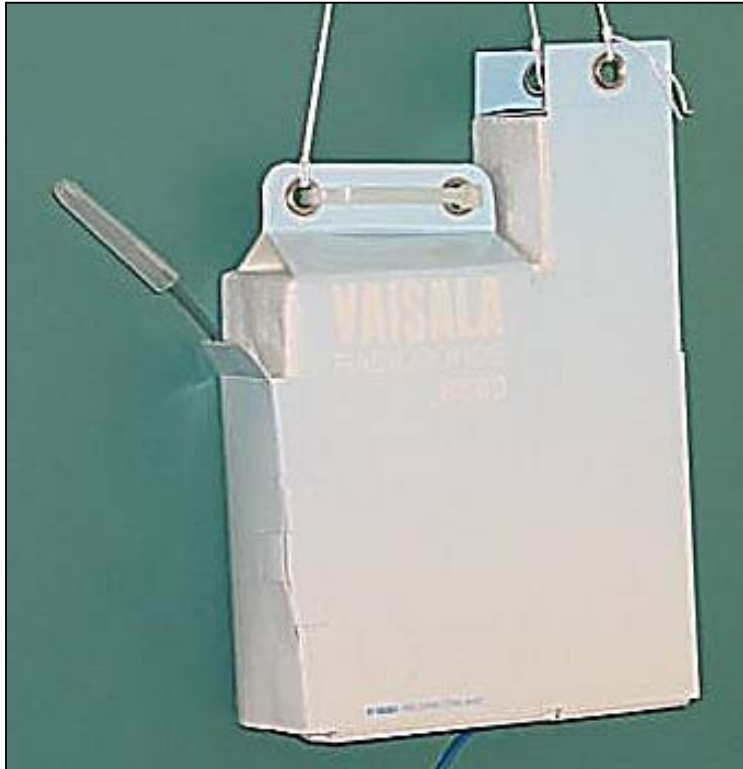
Photo 2.1. A Vaisala RS-80 15G Radiosonde
